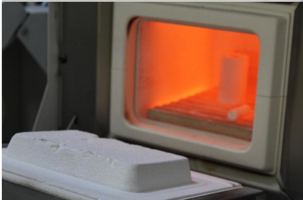
Выбор программного обеспечения на муфельной печи согласно рекомендации производителя поковочной массы для пресс керамики
