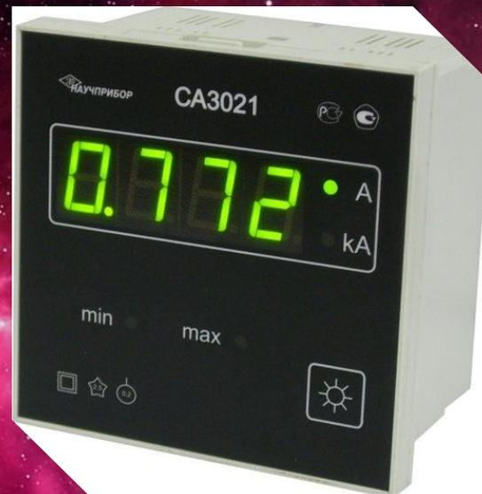
В электрическую цепь амперметр включается последовательно с тем участком электрической цепи, силу тока в котором измеряют. Поэтому, чем ниже внутреннее сопротивление амперметра (в идеале — 0), тем меньше будет влияние прибора на исследуемый объект, и тем выше будет точность измерения.
