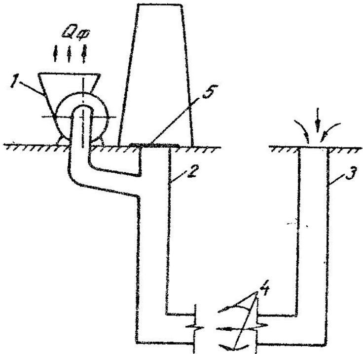
Внешняя сеть шахтной вентиляционной установки – сеть подземных горных выработок, предназначенных для движения воздуха.
