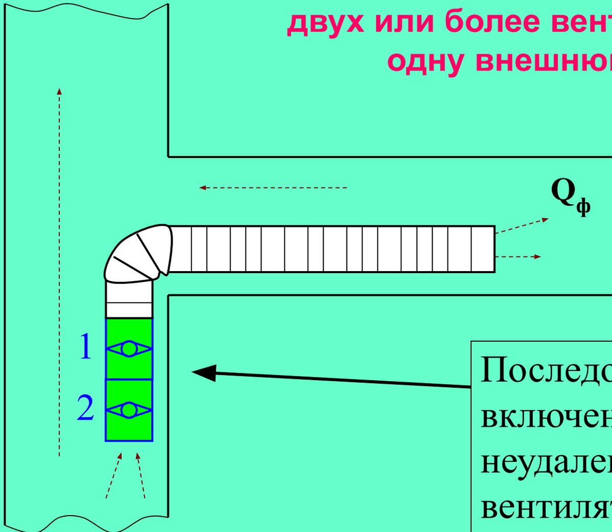
Последовательное включение двух неудаленных вентиляторов
