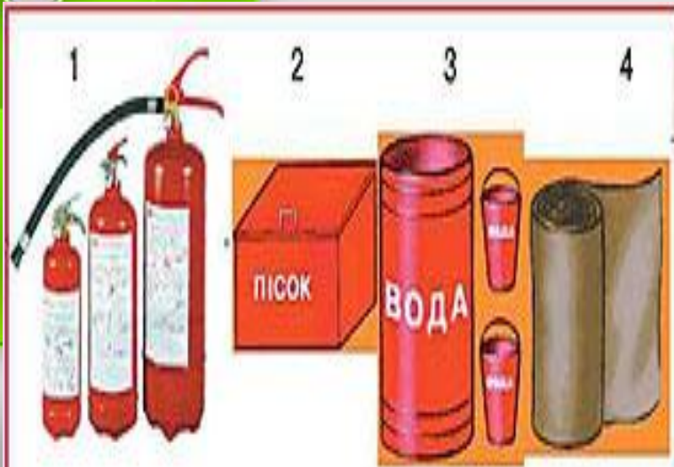
Рисунок 6. Первинні засоби пожежогасіння: 1 – вогнегасники; 2 – ящик з піском; 3 – бочка з водою та відра; 4 – покривало пожежне.
