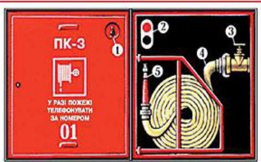
Рисунок 2. Внутрішній пожежний кран: 1 – місце зберігання ключа; 2 – пульт дистанційного запуску насоса-підвищувача; 3 – пожежний кран; 4 – пожежний рукав; 5 – ствол.
