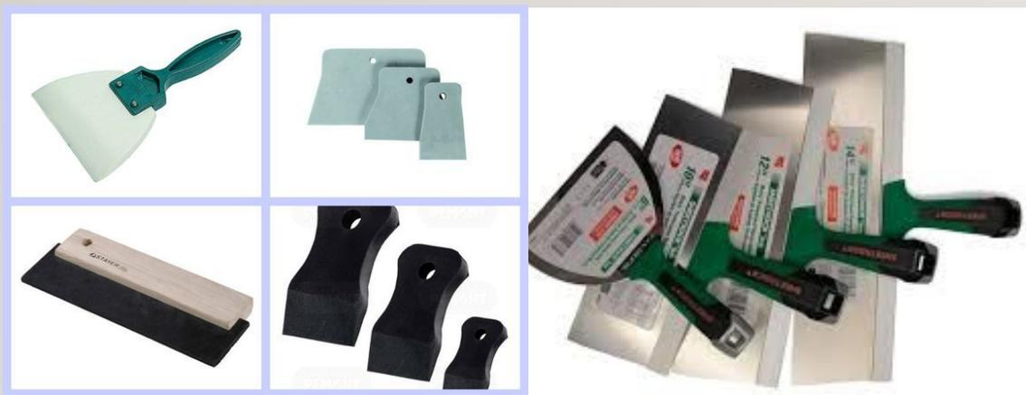
Шпатлевание прямолинейной поверхности выполняют стальным шпателем – небольшой специальной лопаткой, а криволинейных поверхностей – шпателем из толстой резины.
