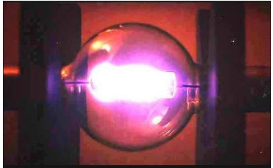
Электронные пучки - это поток быстро летящих электронов в электронных лампах **1** и газоразрядных устройствах **2**.
