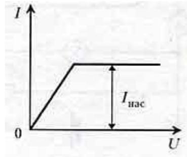
При малых напряжениях на аноде не все электроны, испускаемые катодом, достигают анода, и электрический ток небольшой. При больших напряжениях ток достигает насыщения, т.е. максимального значения. Вакуумный диод используется для выпрямления переменного тока.
