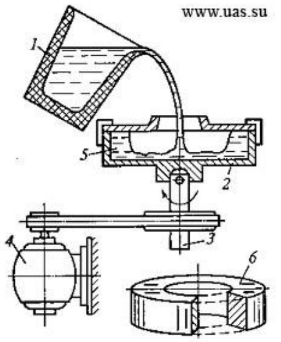
Рисунок 1.2 – Схема получения отливок при вращении формы вокруг вертикальной оси:
