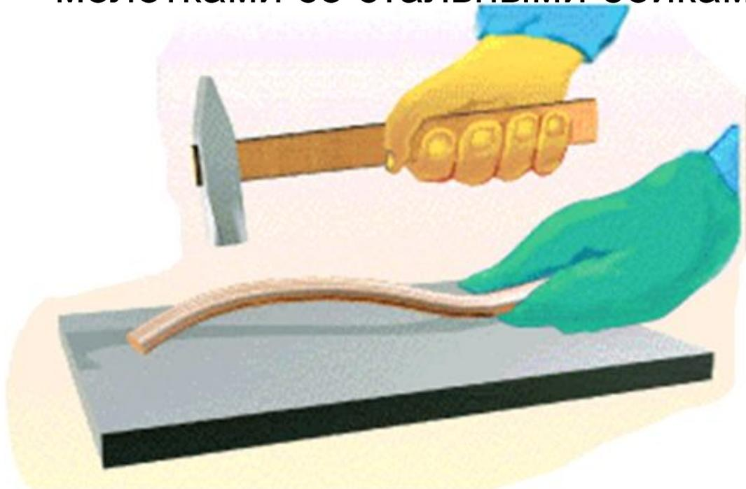
Заготовка располагается на правильной плите изгибом вверх и удары наносят по выпуклым местам, изгибая заготовку в сторону, противоположную имеющемуся изгибу. По мере выправления заготовки силу удара уменьшают.
