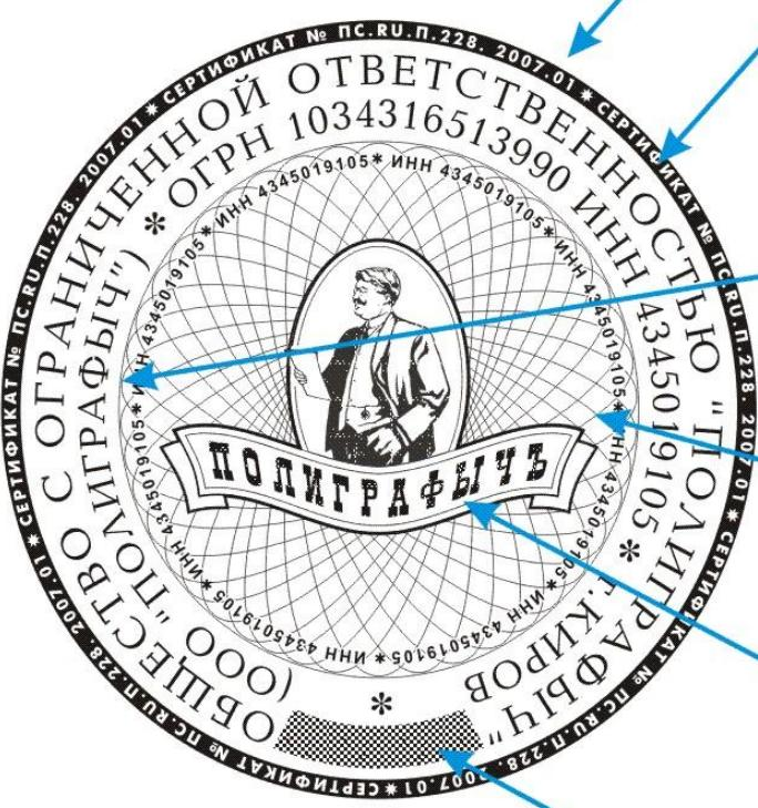
**ИЗМЕНЕНИЕ ПРОПОРЦИЙ** используется для создания визуально неразличимого искажения размеров печати, придания ей неправильной формы.
