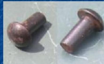
Заклёпка — деталь заклёпочного соединения в виде круглого стержня или трубы, с одной стороны имеющая закладную головку и образующуюся в процессе клёпки замыкающую (высадную) головку
