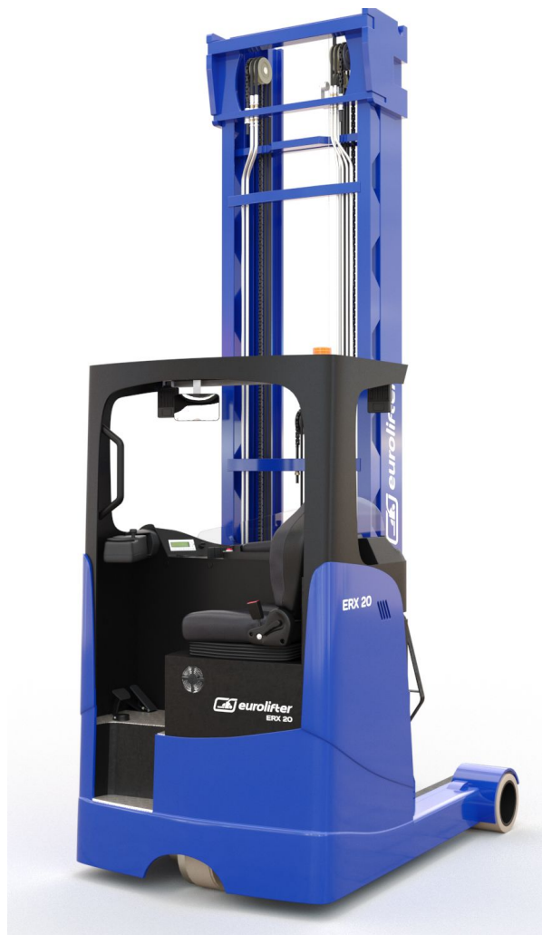
Ричтраки серии ERX грузоподъемностью 1600кг - 2000кг
