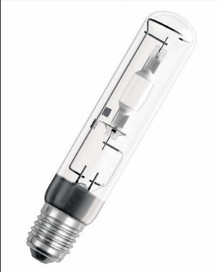
Один из видов газоразрядных ламп высокого давления. Отличается от других ГРЛ тем, что для коррекции спектральной характеристики дугового разряда в парах ртути в горелку МГЛ дозируются специальные излучающие добавки, представляющие собой галогениды некоторых металлов
