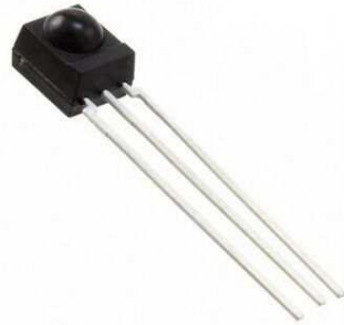
ИК приёмник TSOP
