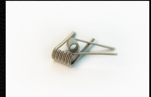
Staggered Fused Clapton \Omega=0,30 \text{ Ом} 2x0, 4Ni80+0, 15Ni80 6 витков на 2,5 мм оправу
