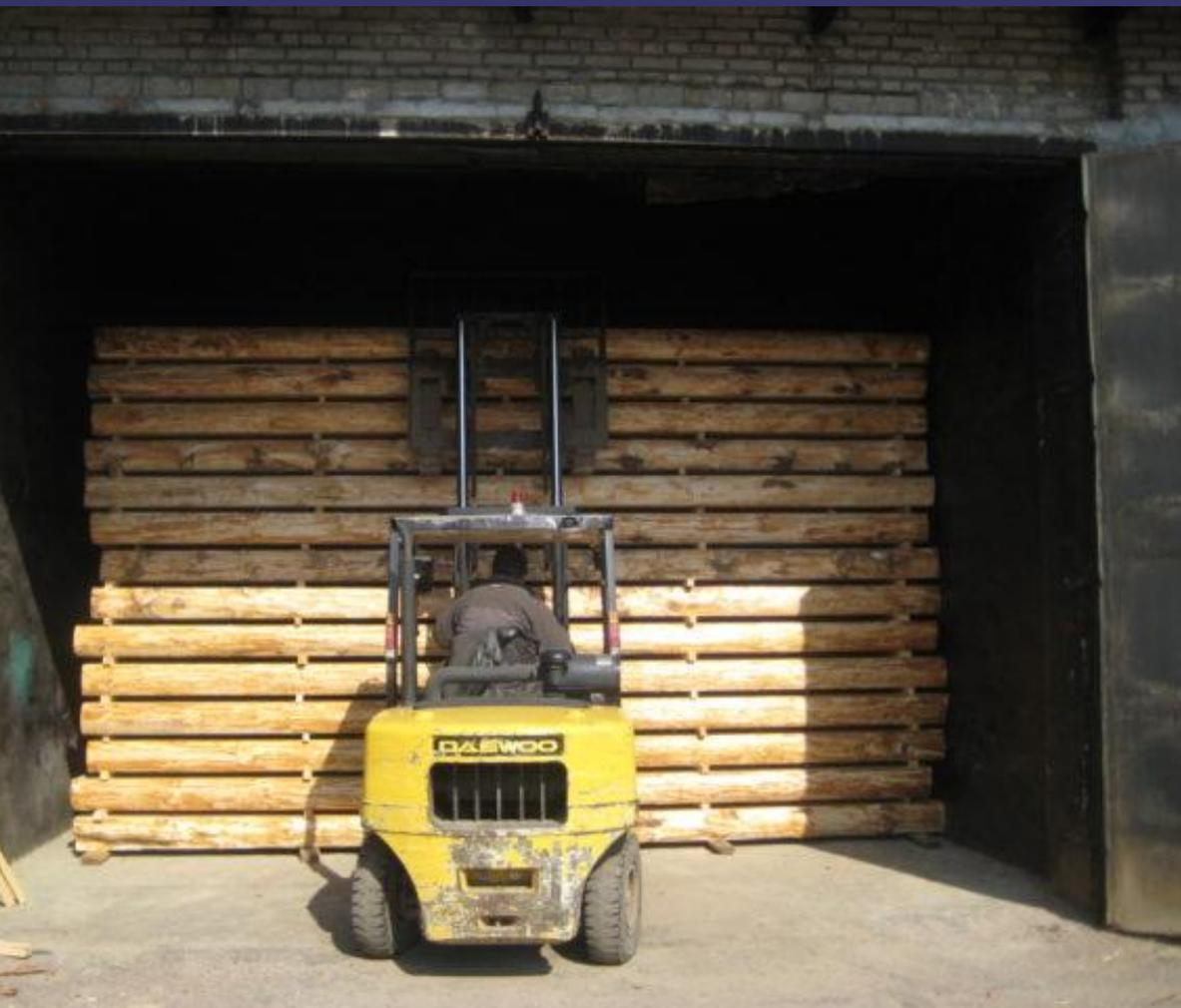
Естественный процесс сушки древесины происходит медленно и долго. Это наиболее щадящий процесс, при котором появляется минимум трещин и других дефектов, чем при агрессивном воздействии в камерах. Для организации такого метода нужно специальное место, где древесина будет защищена от попадания прямых солнечных лучей и осадков.
