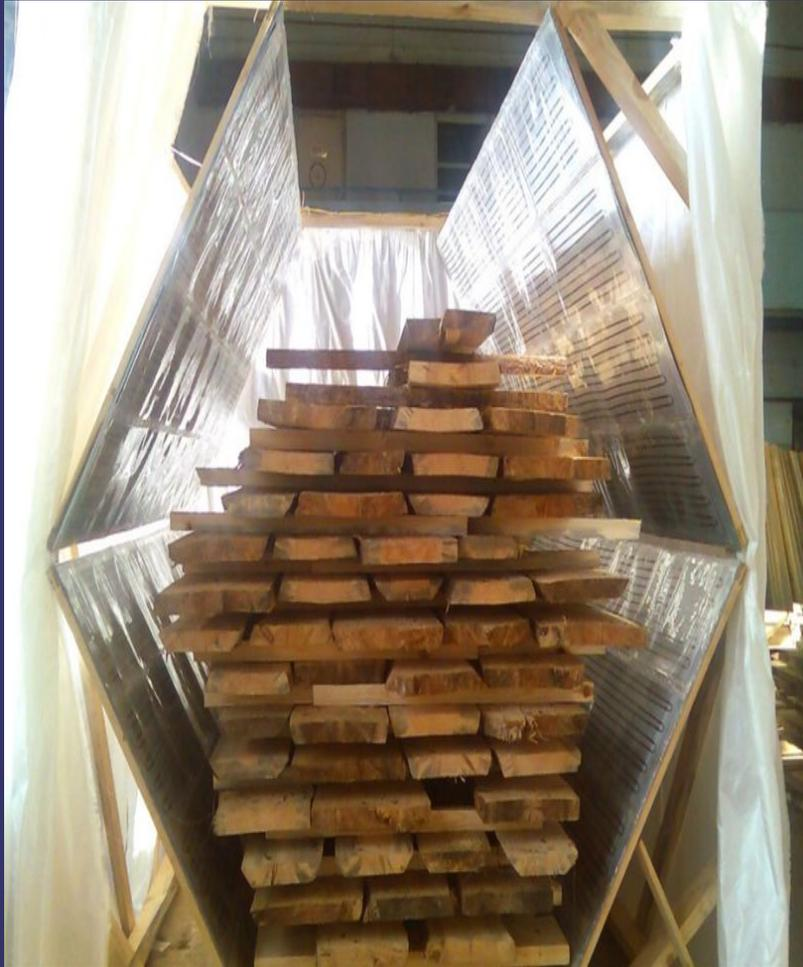
⇒ Инфракрасная сушка древесины — современный способ с использованием оборудования, которое передает тепло с помощью инфракрасного излучения. Это один из самых быстрых вариантов сушки пиломатериалов, который занимает 3-7 дней в зависимости от вида дерева. Время сушки опилок составит полчаса. Процесс происходит при температуре 50-60 градусов, что сохраняет структуру дерева и защищает его от растрескивания.
