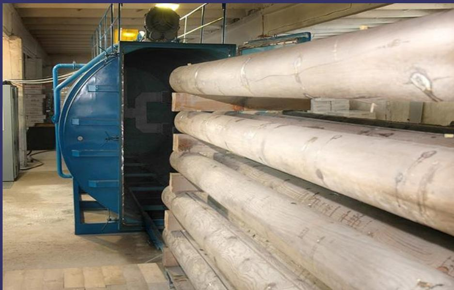
Вакуумная сушка древесины предполагает использование камеры, в которой образуется вакуум. Этот универсальный способ подходит для любого вида пиломатериалов и древесины. Он объединяет старые технологии и совмещает с современными. Процесс отличается высоким качеством и оперативностью. На сушку бревна диаметром 250 мм или на брус сечением 150x150 уходит 17-20 часов.
