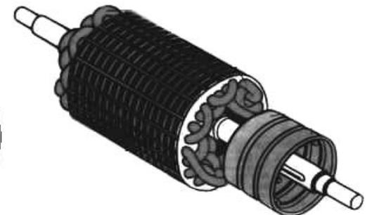
Для снижения магнитного сопротивления стремятся сделать минимальным зазор между статором и ротором.
