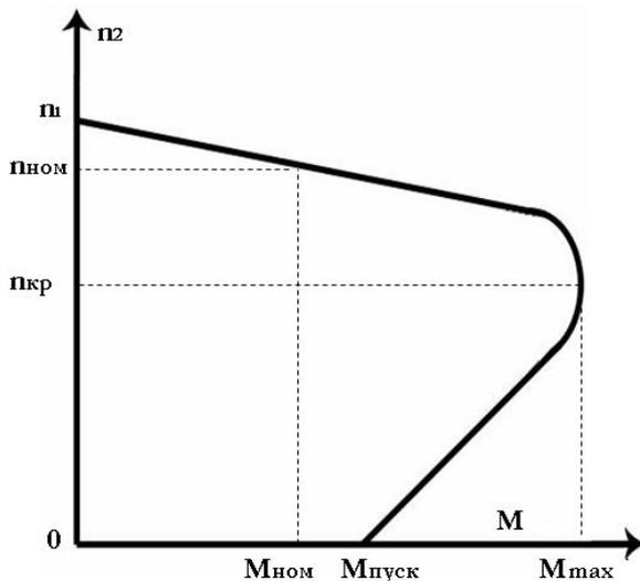
Рабочая область механической характеристики – область частот выше  $n_{кр}$ . В этой области ТАД обладает свойством саморегулирования. При частотах меньше критической свойства саморегулирования нет, и двигатель работает неустойчиво.
