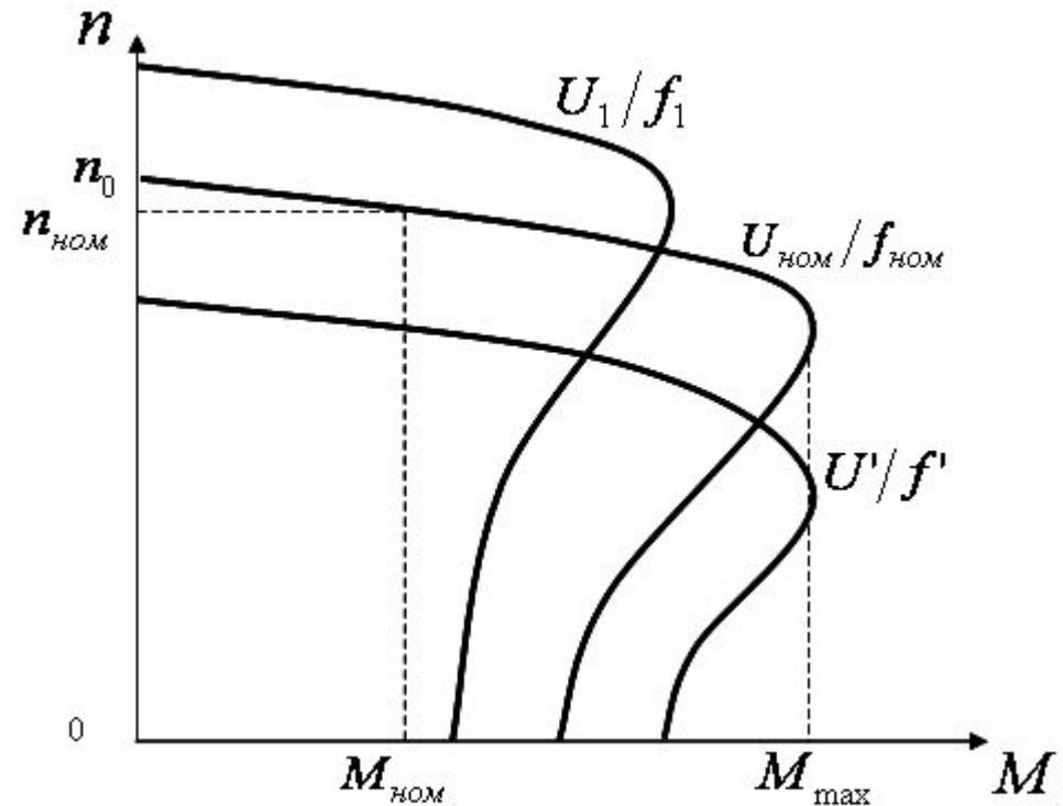
Для сохранения перегрузочной способности (чтобы максимальный момент оставался постоянным) при регулировании должно выполняться условие
