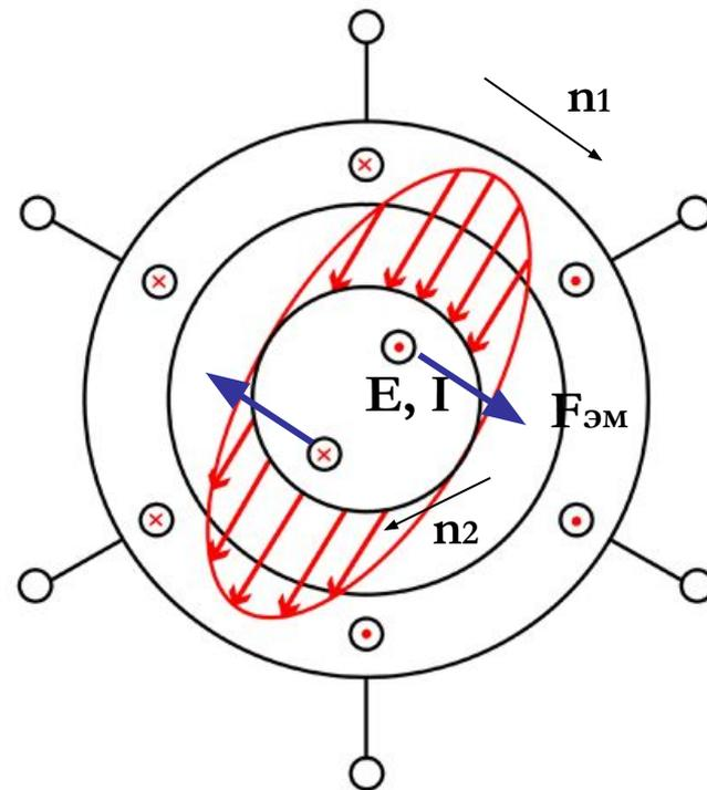
Если теперь появится момент нагрузки (тормозящий), частота вращения ротора упадет, ротор будет вращаться медленнее поля статора. Из-за этого появится ЭДС ротора и ток ротора, а, следовательно, и сила Ампера и вращающий момент. Момент будет увеличиваться до тех пор, пока частота вращения снижается, а частота снижается до момента, когда момент вращения ТАД не уравновесит момент нагрузки. Так ТАД автоматически поддерживает момент вращения равным моменту нагрузки – свойство саморегулирования.
