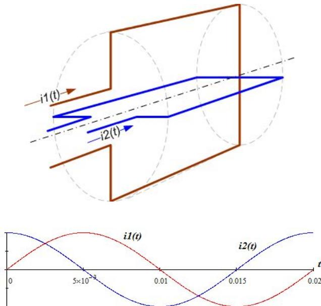
Две катушки расположены под углом  $90^\circ$  в пространстве. Токи в катушках отличаются по фазе на  $90^\circ$ . Таким образом каждая из катушек создает магнитное поле, отличающееся фазой и направлением в пространстве на угол  $90^\circ$ .
