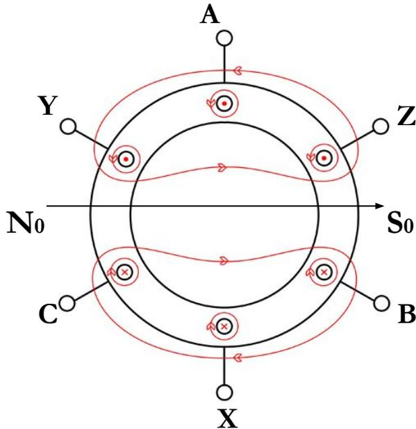
Статор представляет собой полый цилиндр из ферромагнитного материала, на внутренней поверхности которого есть пазы, в которые укладывается трехфазная обмотка –  $3 \cdot p$  катушек. Катушки смещены в пространстве на  $120/p$  градусов. Для наиболее простого случая трех катушек угол  $120$  как на рисунке.
