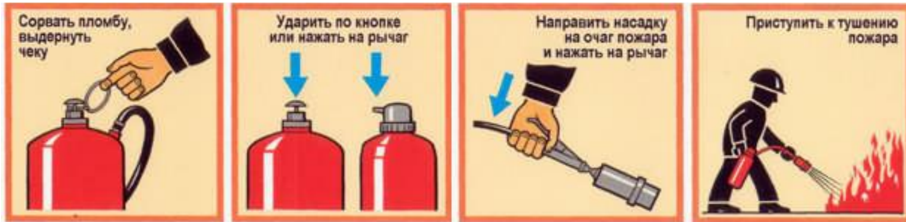
Приведение в действие пенного огнетушителя
