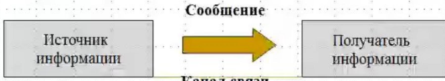
**Канал связи** – совокупность технических устройств, обеспечивающих передачу данных от *передатчика* к *приемнику*
