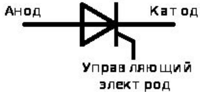
***Тиристором*** называют полупроводниковый прибор, состоящий из четырех последовательно чередующихся областей с различным типом проводимости, обладающий бистабильной характеристикой. Тиристоры способны управляемо переключаться из одного состояния в другое. В первом состоянии тиристор имеет высокое сопротивление и малый ток (*закрытое состояние*), в другом – низкое сопротивление и большой ток (*открытое состояние*).
