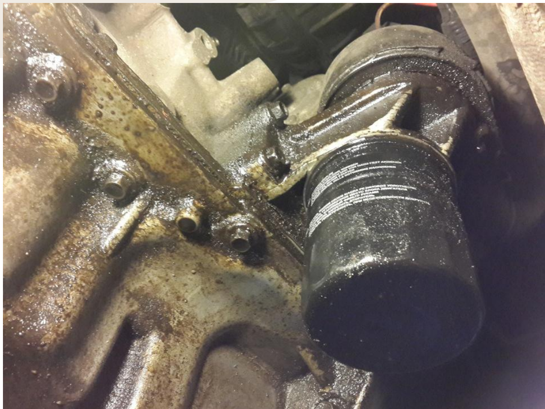
Неплотность технологического оборудования (течет масло)
