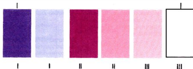
Рисунок 2 – Цветовая шкала для определения класса молока по редуктазной пробе с резазурином
