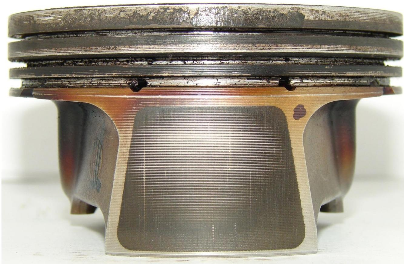
Пример, образец идеальной фотографии поршня. Вид с ненагруженной стороны юбки. Ненагруженная сторона обозначена точкой в правой верхней части юбки поршня. Одна точка свидетельствует о том, что это поршень первого цилиндра.
