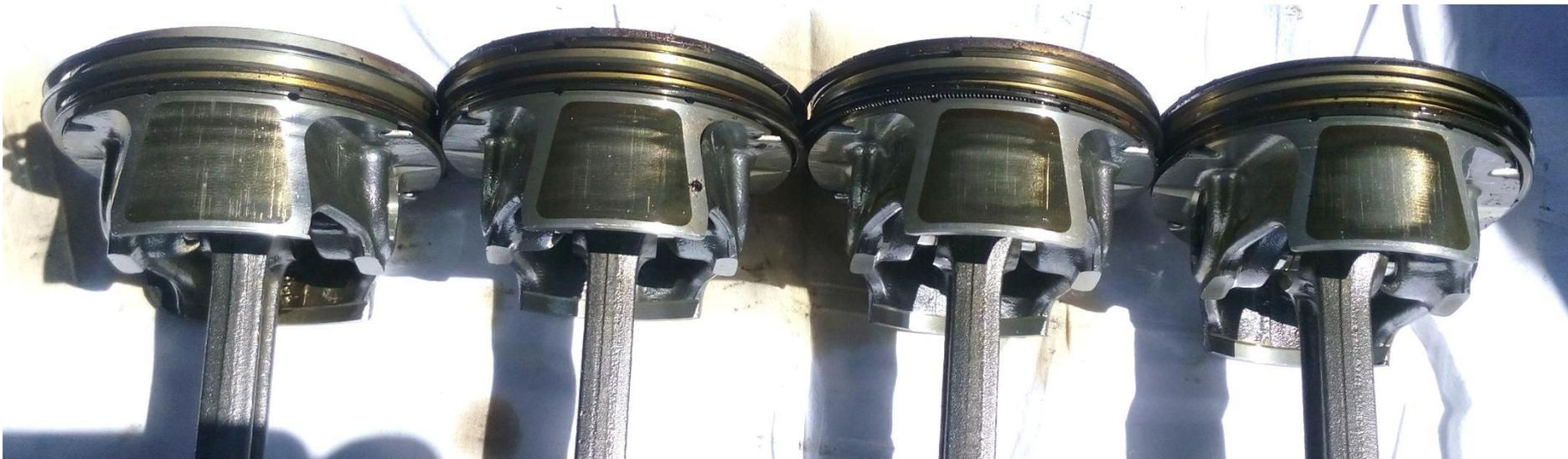
**В случае, когда поршни с шатунами в сборе (что характерно для ПССС), можно для сравнения пятен контакта фотографировать поршни все сразу таким образом. Главное, чтобы поверхность поршней на фото была четкой, резкой, хорошо сфокусированной.**
