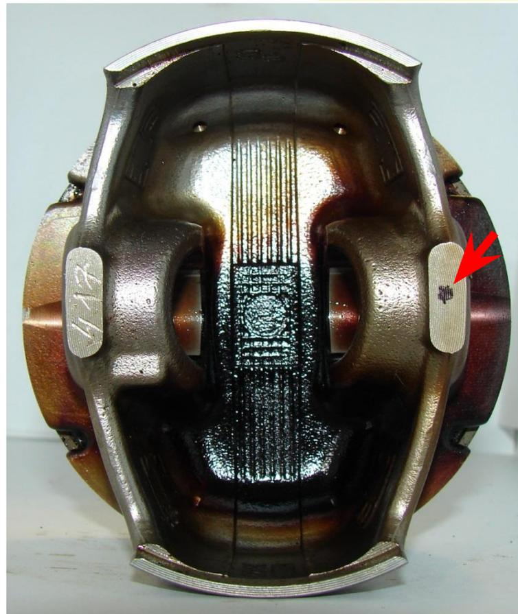
Пример, образец идеальной фотографии поршня. Виды сверху и снизу. Одна точка на приливе на виде снизу (см. стрелку) и цифра «1» на виде сверху свидетельствуют о том, что это поршень первого цилиндра.
