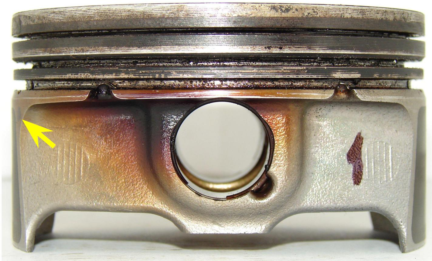
Пример, образец идеальной фотографии поршня. Вид сбоку. Ненагруженная сторона обозначена точкой в левой верхней части левой юбки поршня (см. стрелку). Одна точка и цифра «1» свидетельствуют о том, что это поршень первого цилиндра.
