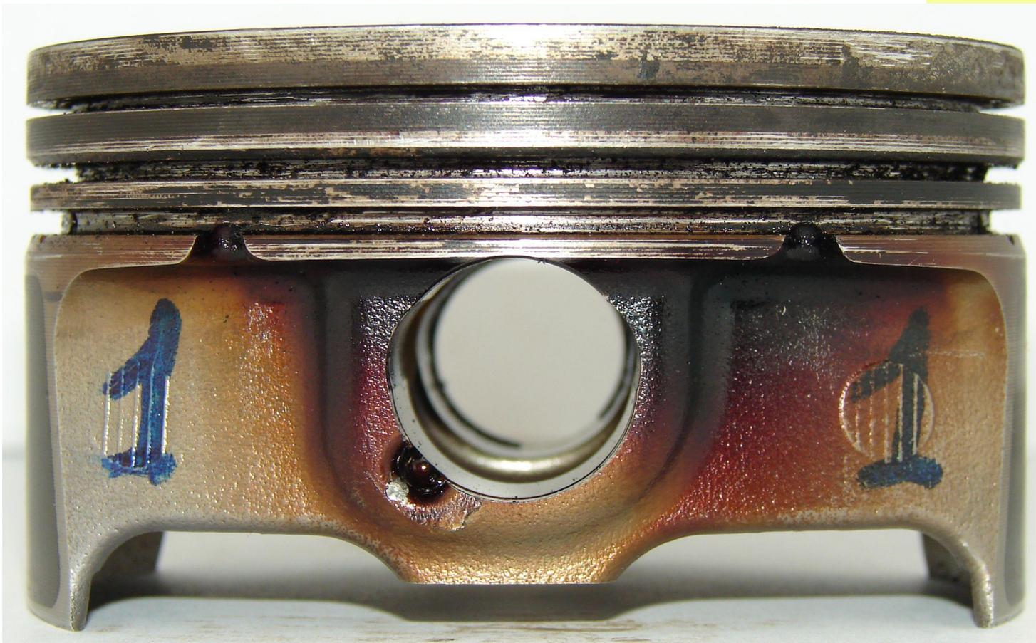
**Пример, образец идеальной фотографии поршня. Вид сбоку. Нагруженная сторона обозначена горизонтальной полоской в левой верхней части левой юбки поршня. Одна полоска и цифры «1» свидетельствуют о том, что это поршень первого цилиндра.**
