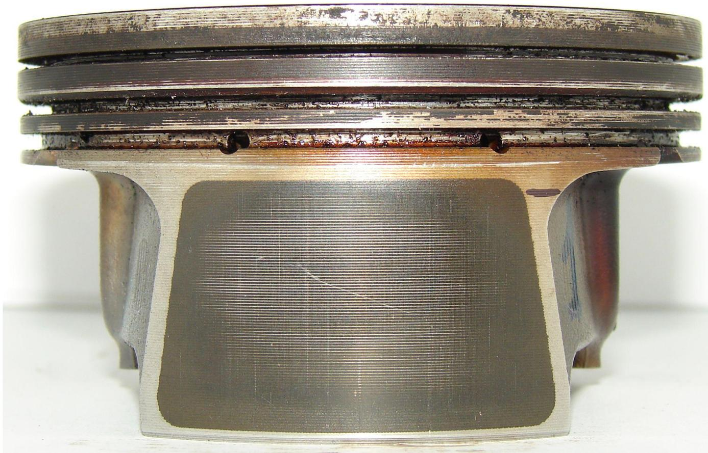
Пример, образец идеальной фотографии поршня. Вид с нагруженной стороны юбки. Нагруженная сторона обозначена горизонтальной полоской в правой верхней части юбки поршня. Одна полоска свидетельствует о том, что это поршень первого цилиндра.
