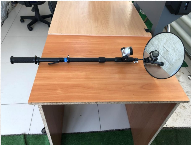
Сферическое зеркало с рукояткой для досмотра автотранспортных средств
