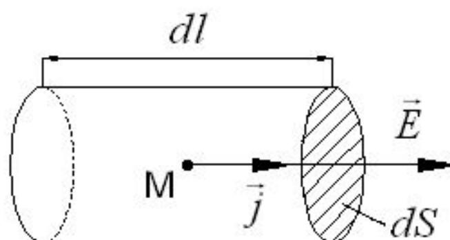
в точке  $M$  (рис. 3). Пусть длина выделенного цилиндра  $dl$ , площадь основания  $dS$ . Электрическое поле внутри такого элементарного объема можно считать однородным, сопротивление выделенного объема:
