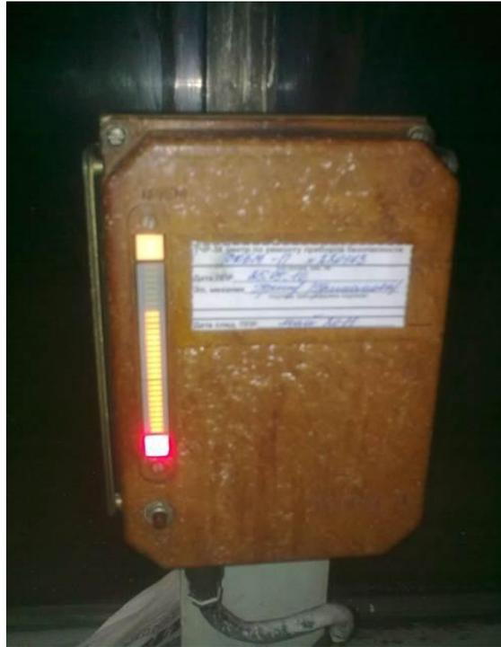
**Прибор ТСКБМ-П, приемник сигналов прибора ТСКБМ-Н, предназначен для приема и первичной обработки информации, передаваемой по радиоканалу от ТСКБМ-Н и передачи ее в контроллер ТСКБМ-К, а также световой сигнализации о проверке работоспособности машиниста.**
