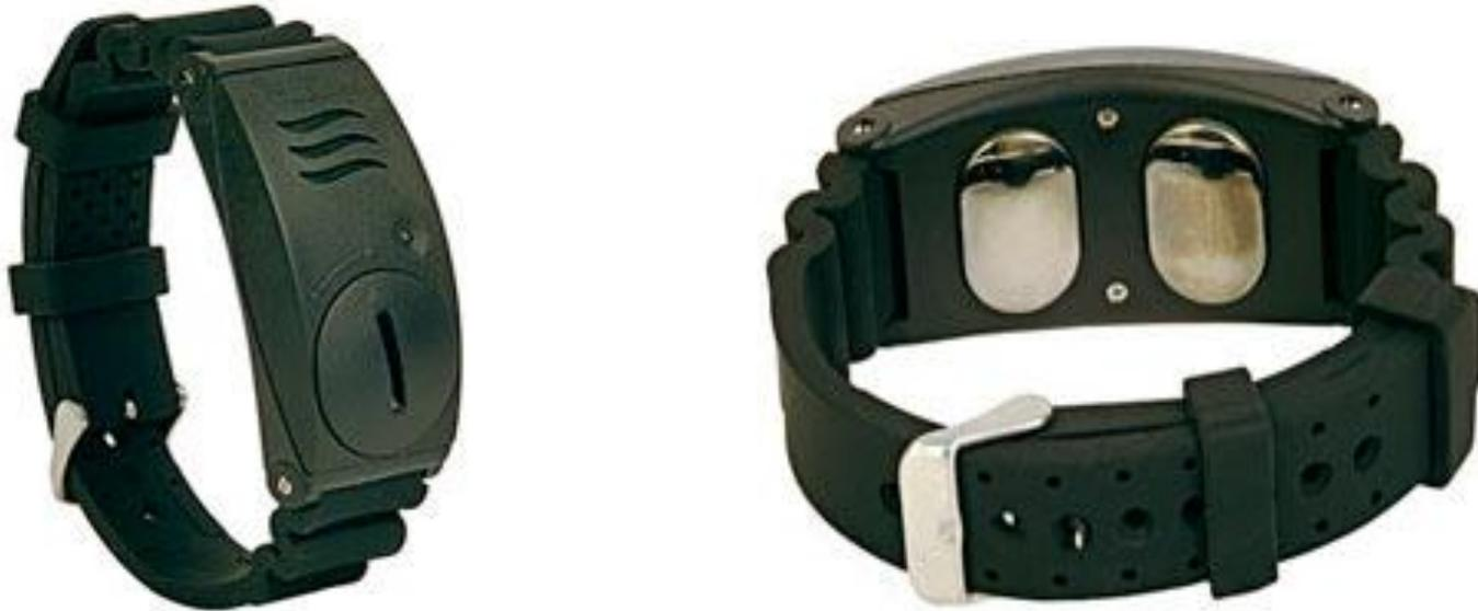
Прибор ТСКБМ-Н, носимая часть, представляет собой телеметрический датчик и располагается на запястье машиниста. Прибор ТСКБМ-Н предназначен для получения информации об относительном изменении электрического сопротивления кожи и передачи ее по радиоканалу в цифровом виде на приемник ТСКБМ-П.
