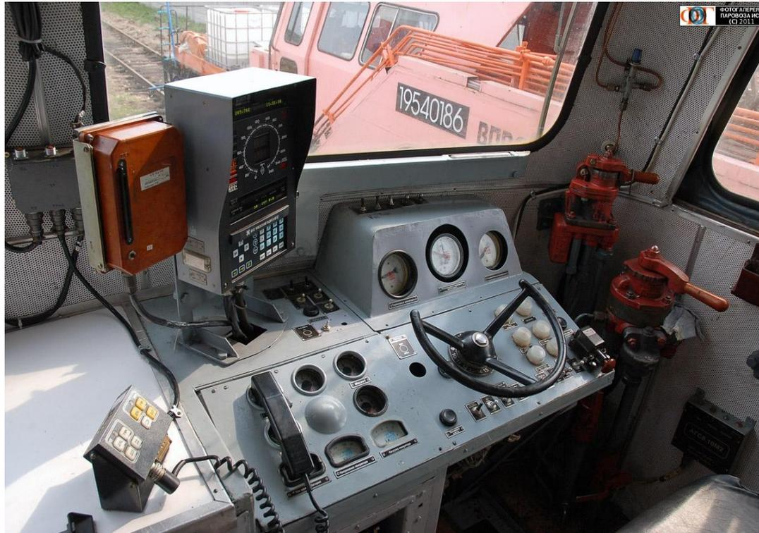
**Телемеханическая система контроля бодрствования предназначена для обеспечения непрерывного контроля психофизиологического состояния машиниста и поддержания его в работоспособном состоянии**
