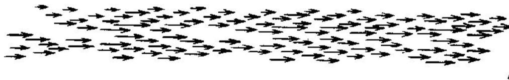
Рис. 7. Рассчитанная на ЭВМ структура границы  $\Sigma 89$   $145,1^\circ$   $[\bar{1}10]$  в алюминии [48]:
