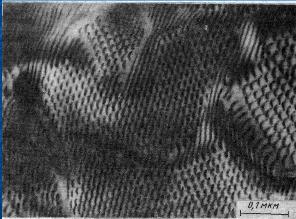
Сетка ЗГД, создающая отклонение  $0,5^\circ$  от разориентировки  $36,9^\circ$  [001] в границе кручения  $\Sigma 5$  в тонкопленочном бикристалле золота
