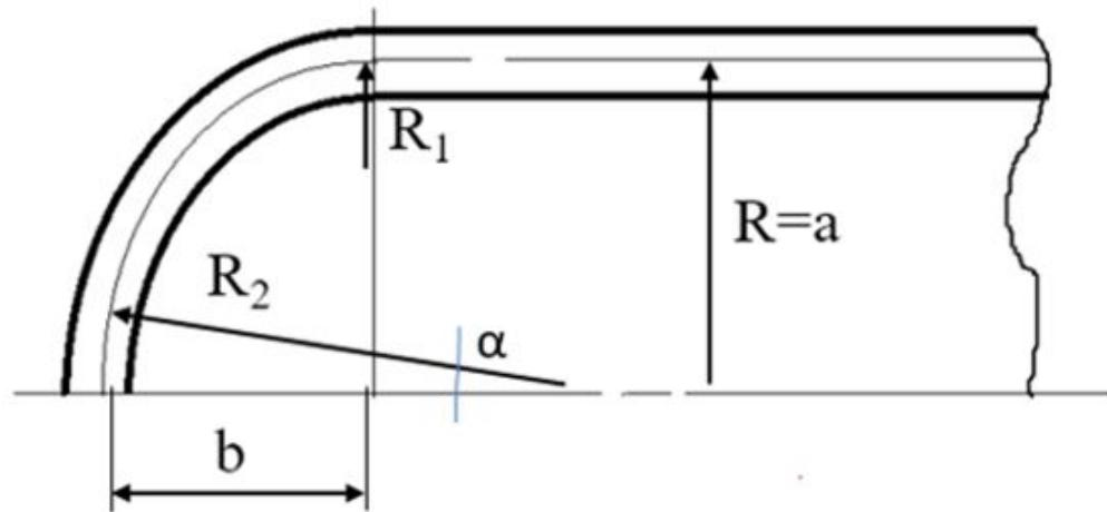
$$\frac{\sigma_1}{R_1} + \frac{\sigma_2}{R_2} = \frac{p}{h} \quad - \text{ уравнение Лапласа.}$$
