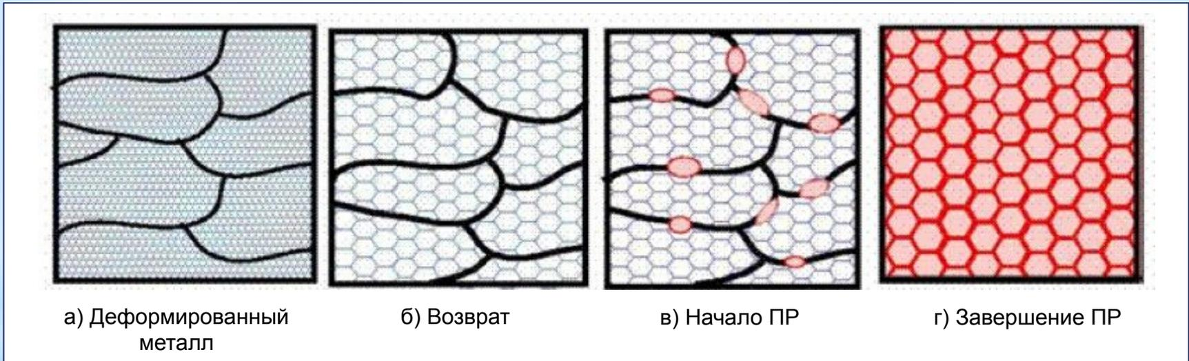
Новые рекристаллизованные зерна в первую очередь возникают в волокнистой структуре холоднодеформированного металла в местах с максимальной плотностью дислокаций: на межзеренных и на межфазных границах. В результате протекания процесса первичной рекристаллизации волокнистая структура деформированного металла заменяется на мелкозернистую равноосную - рекристаллизованную структуру.
