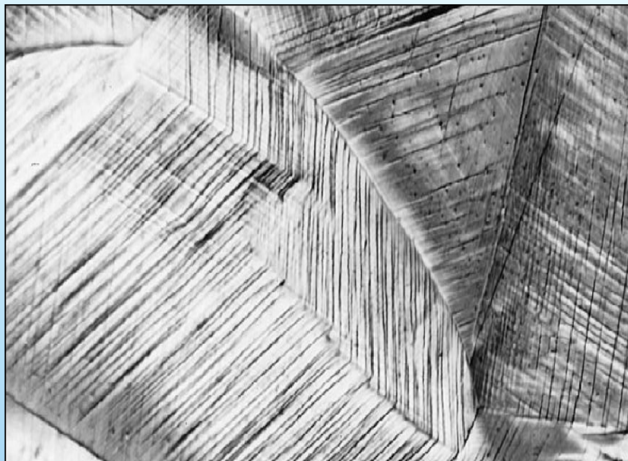
Линии скольжения на полированной поверхности деформированной меди, \times 173
