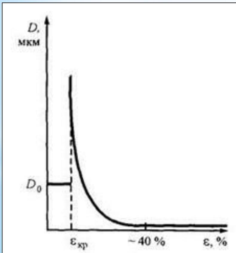
**Чем выше степень предварительной холодной пластической деформации, тем ниже температура начала первичной рекристаллизации и мельче рекристаллизованное зерно.**
