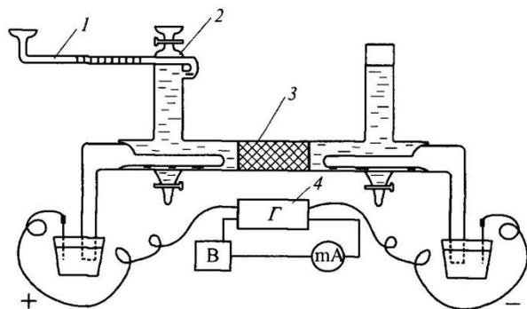
Рис. 4.31. Прибор Перрена для измерения скорости электроосмоса
