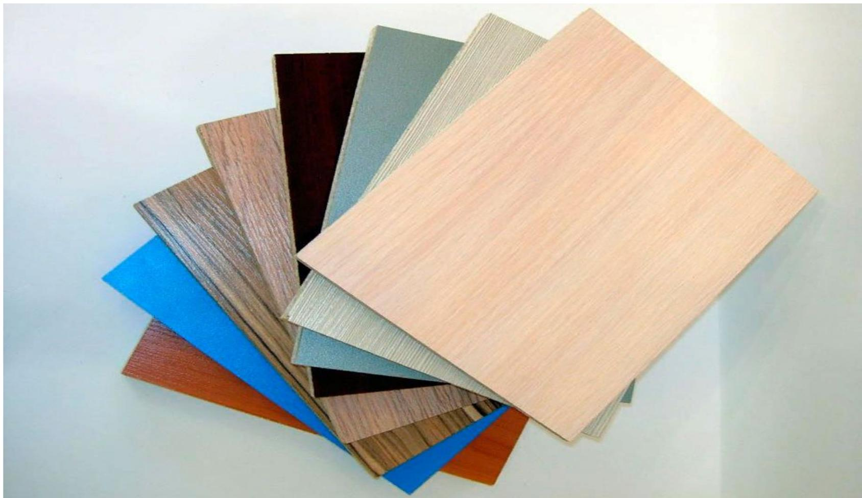
**Ламинированная древесно-стружечная плита (официальная аббревиатура — ЛДСП, неофициально — ЛДСП) — листовой композиционный материал, изготовленный путём горячего прессования древесных частиц, преимущественно стружки, смешанных со связующим веществом неминерального происхождения с введением при необходимости специальных добавок.**
