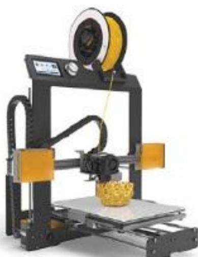
Рис. 9.39. 3D-принтер ниточной печати
