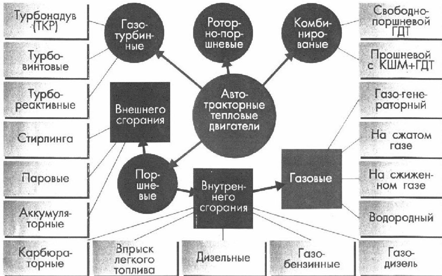
**Поршневым двигателем внутреннего сгорания (ДВС)** называют такую тепловую машину, в которой превращение химической энергии топлива в тепловую, а затем в механическую энергию, происходит внутри рабочего цилиндра.
