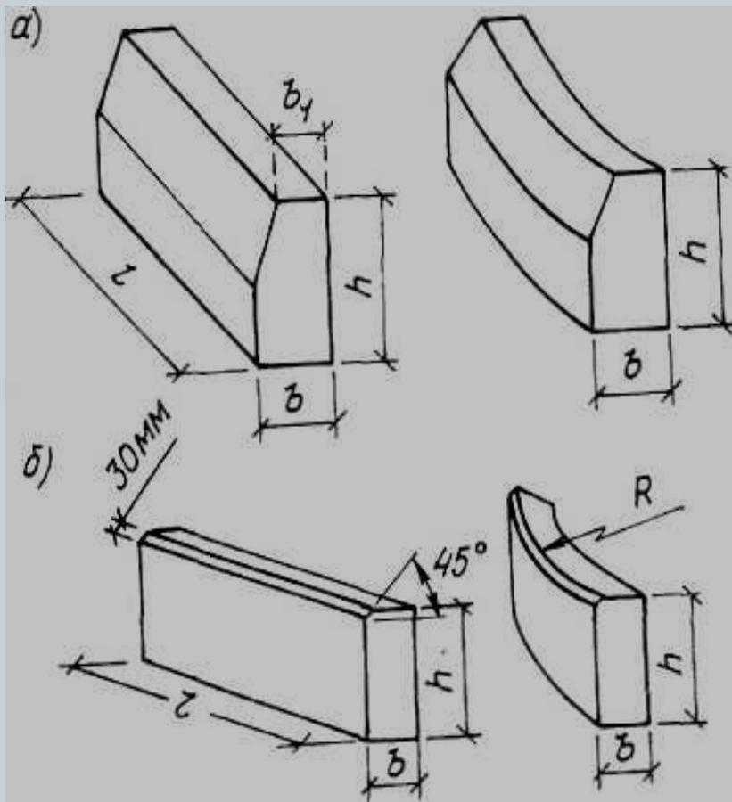
а - бетонные; б - гранитные
