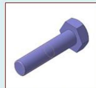
Чертежи крепежных соединений рекомендуется вычерчивать упрощенно. Это заключается в следующем. Фаски на шестигранных и квадратных головках болтов и гаек, а также на стержне не изображают.
