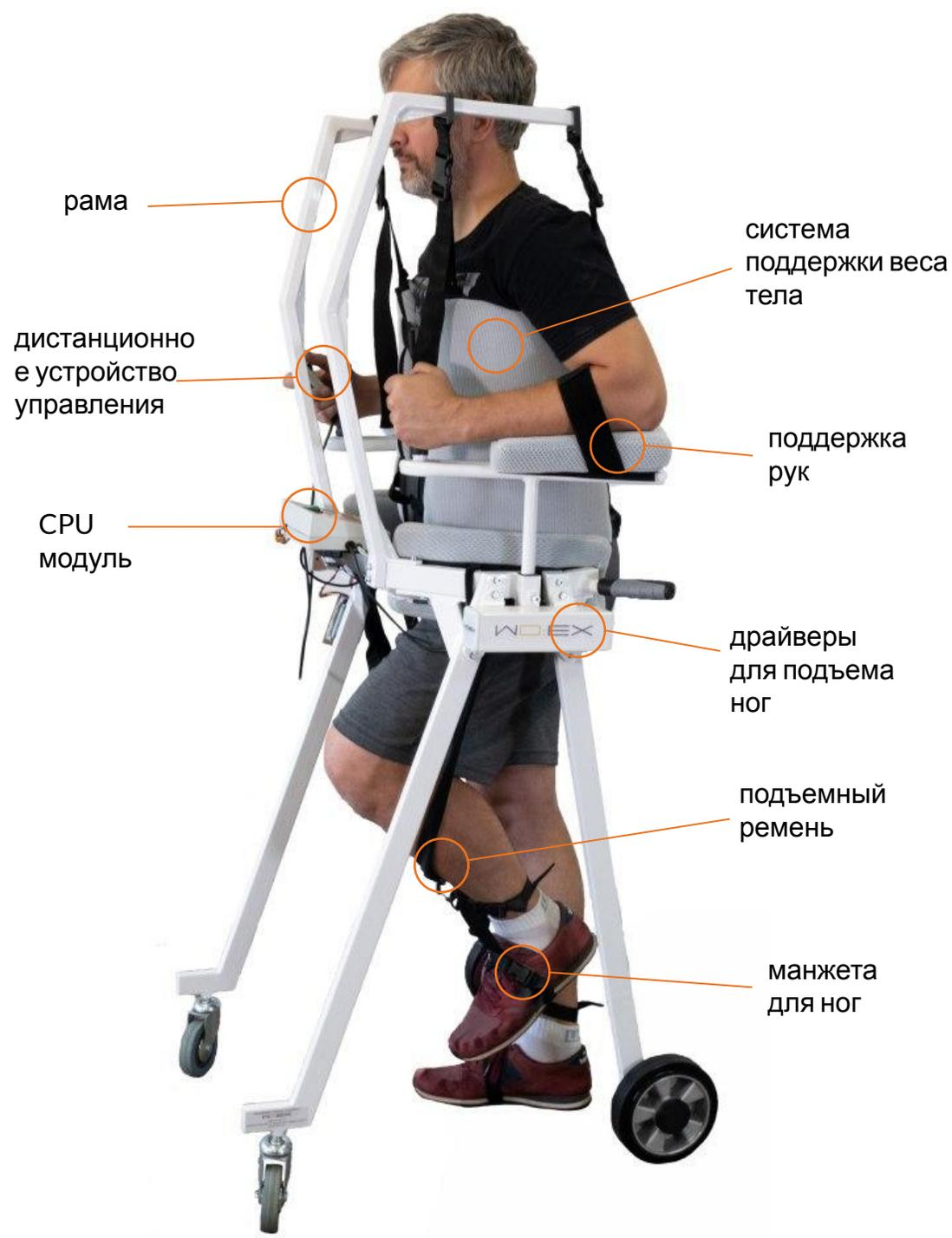
WO:EX состоит из мобильной антигравитационной рамы и подвесной системы, которые соединяются между собой. На голени и стопы пользователя одеваются манжеты, связанные с системой роботизированного подъема нижних конечностей.
