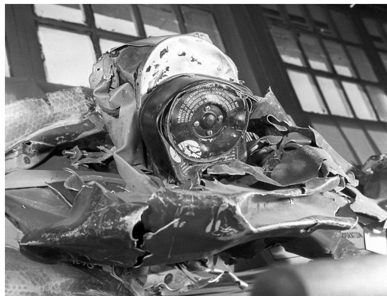
Одна из деталей автоматического радиокompаса
