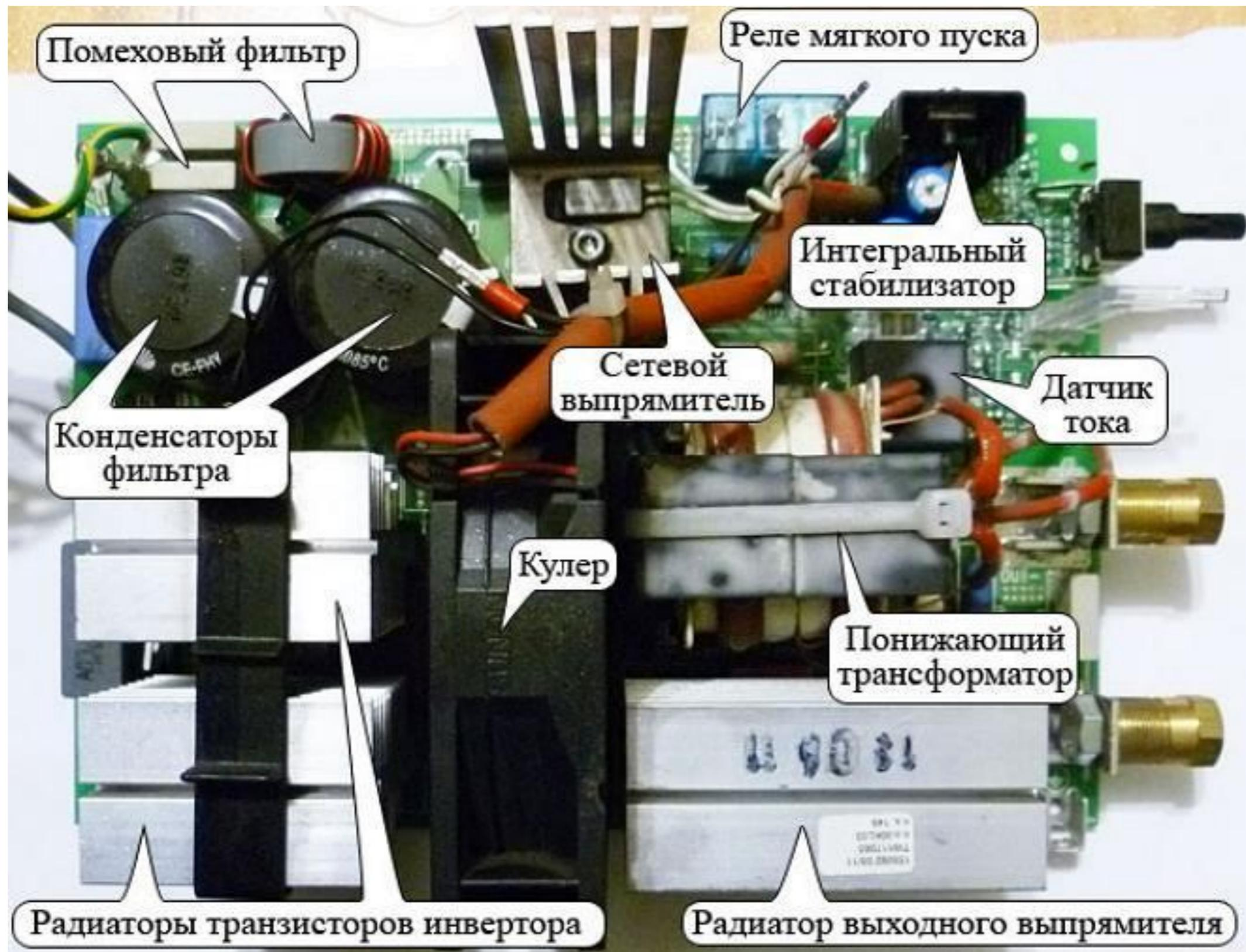
Внутреннее устройство сварочного инвертора
