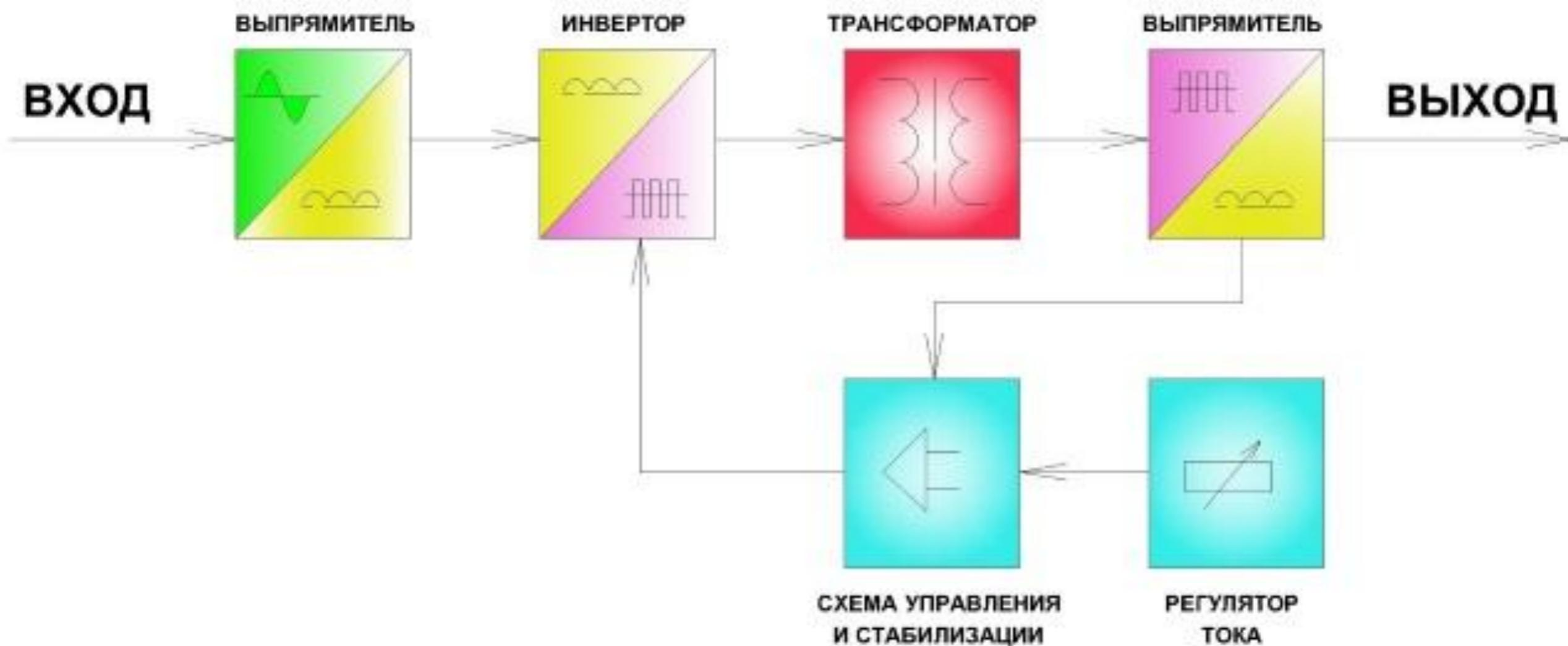
Схема работы инверторного сварочного аппарата
