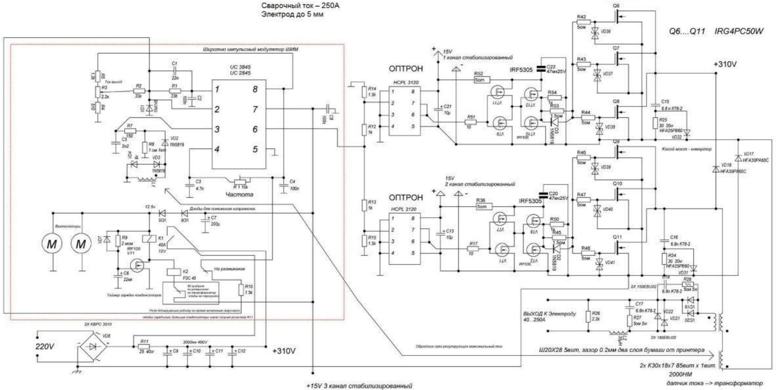
Пример принципиальной схемы инвертора
