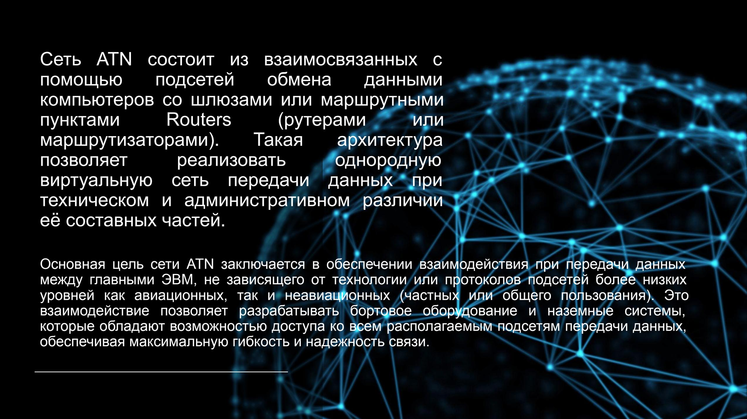
Сеть АТН состоит из взаимосвязанных с помощью подсетей обмена данными компьютеров со шлюзами или маршрутными пунктами Routers (рутерами или маршрутизаторами). Такая архитектура позволяет реализовать однородную виртуальную сеть передачи данных при техническом и административном различии её составных частей.
