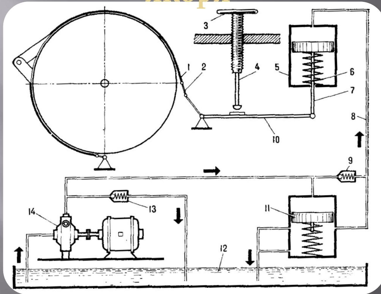
1 – тормозная лента; 2 – тяга; 3 – маховик; 4 – винт; 5 – гидроцилиндр; 6 – пружина;
