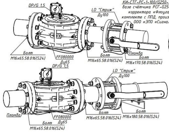
КИ-СТГ-РС-1-100/G250-1А-Л на базе счётчика РСГ-G250 Ду100, корректора «Флоугаз» в комплекте с ППД, производства ООО «ЭПО «Сигнал»
