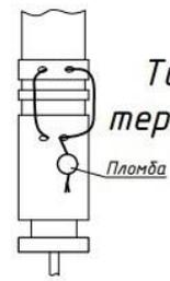
**Типовая пломбировка термодатчика и датчика давления**
