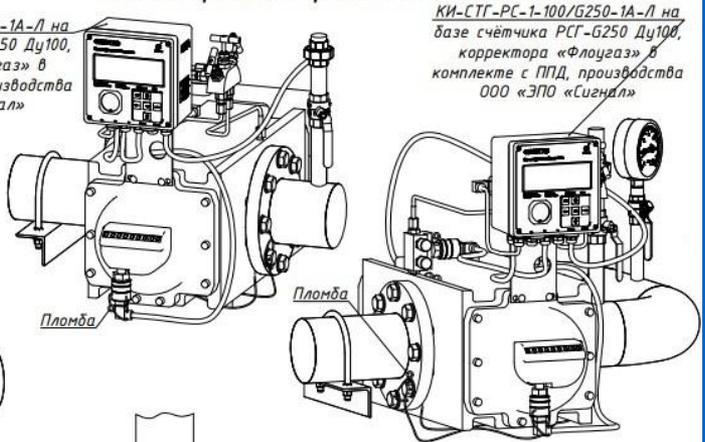
КИ-СТГ-РС-1-100/G250-1А-Л на базе счётчика РСГ-G250 Ду100, корректора «Флоугаз» в комплекте с ППД, производства ООО «ЭПО «Сигнал»
