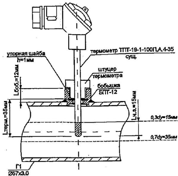
Если датчик установлен на трубопроводе, монтаж должен соответствовать требованиям ГОСТ 8.586-2005, ГОСТ Р 8.740-2011 и ГОСТ 8.611-2013
