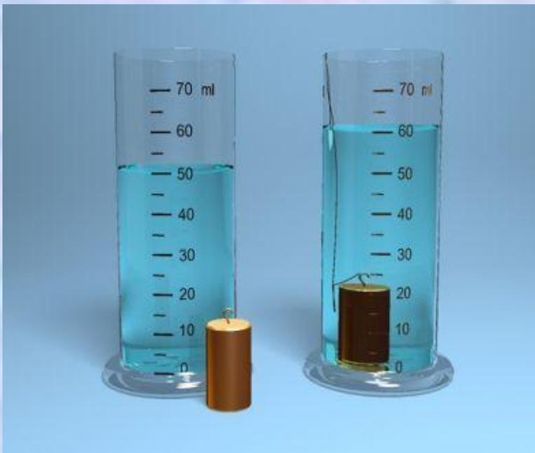
1. Измерьте объем воды в цилиндре ( $V_1$ ).
