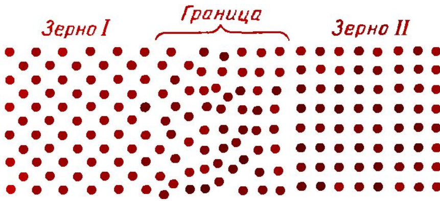
Схема строения большеугловых границ
