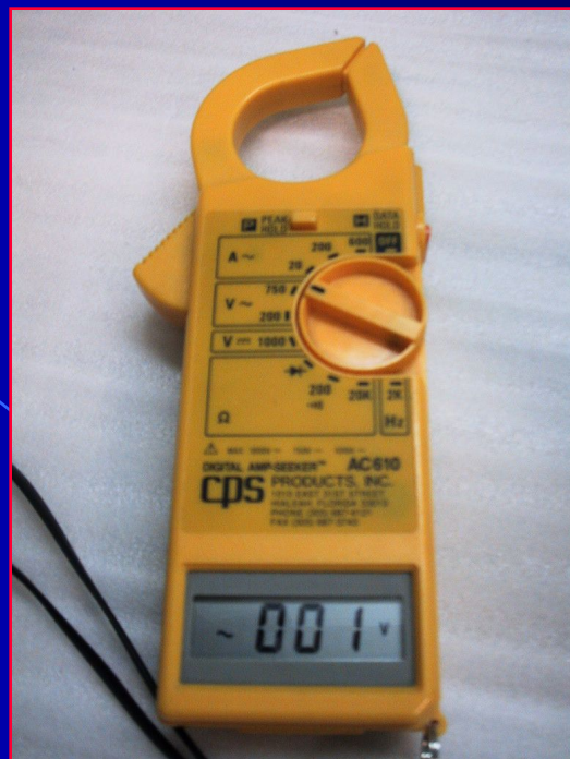
ТОКОВЫЕ КЛЕЩИ С ФУНКЦИЕЙ «Peak hold»
