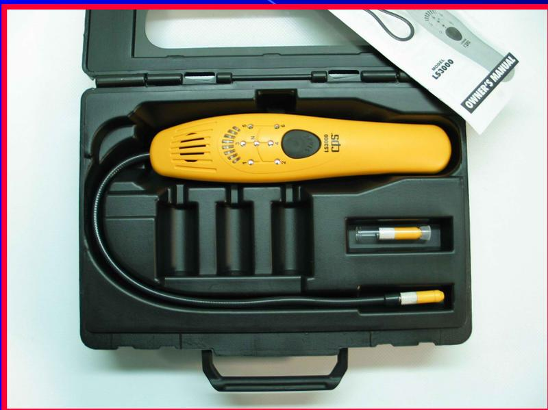
Электронный течеискатель для R134a
