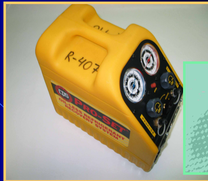
Станция откачки хладагентов
