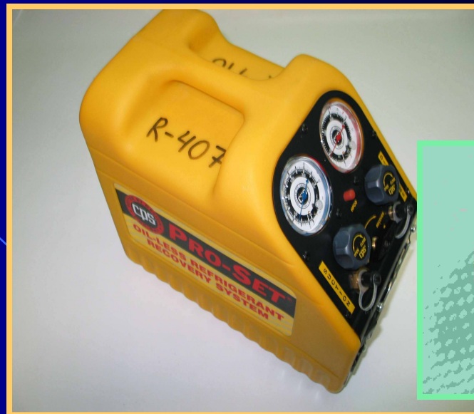
Станция откачки хладагентов
