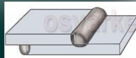
Сварное соединение, в котором сваренные элементы расположены параллельно и частично перекрывают друг друга
