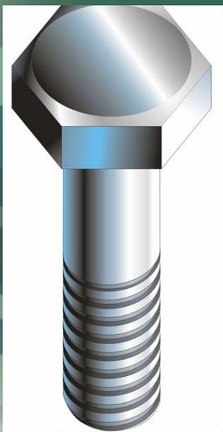
При приложении к такому соединению внешнего усилия имеют место значительные перемещения, обусловленные разностью в диаметрах болта и отверстия, а также неодновременностью вступления в работу всех болтов соединения. По этой причине болты класса точности С ставятся конструктивно без расчетов
