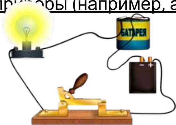
Пример самой простой электрической цепи — это лампочка, подключенная к источнику тока. С помощью выключателя можно размыкать и замыкать цепь, выключая или включая лампочку.
