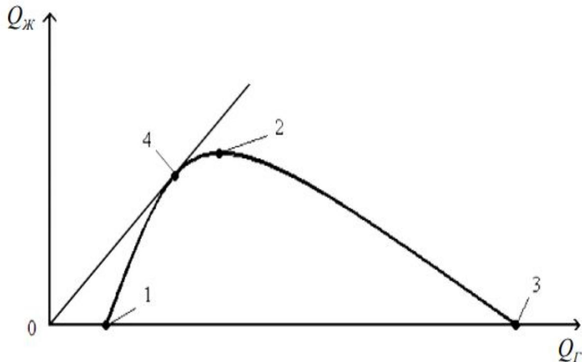
**Рис. 1.5** Характеристика газожидкостного подъемника
