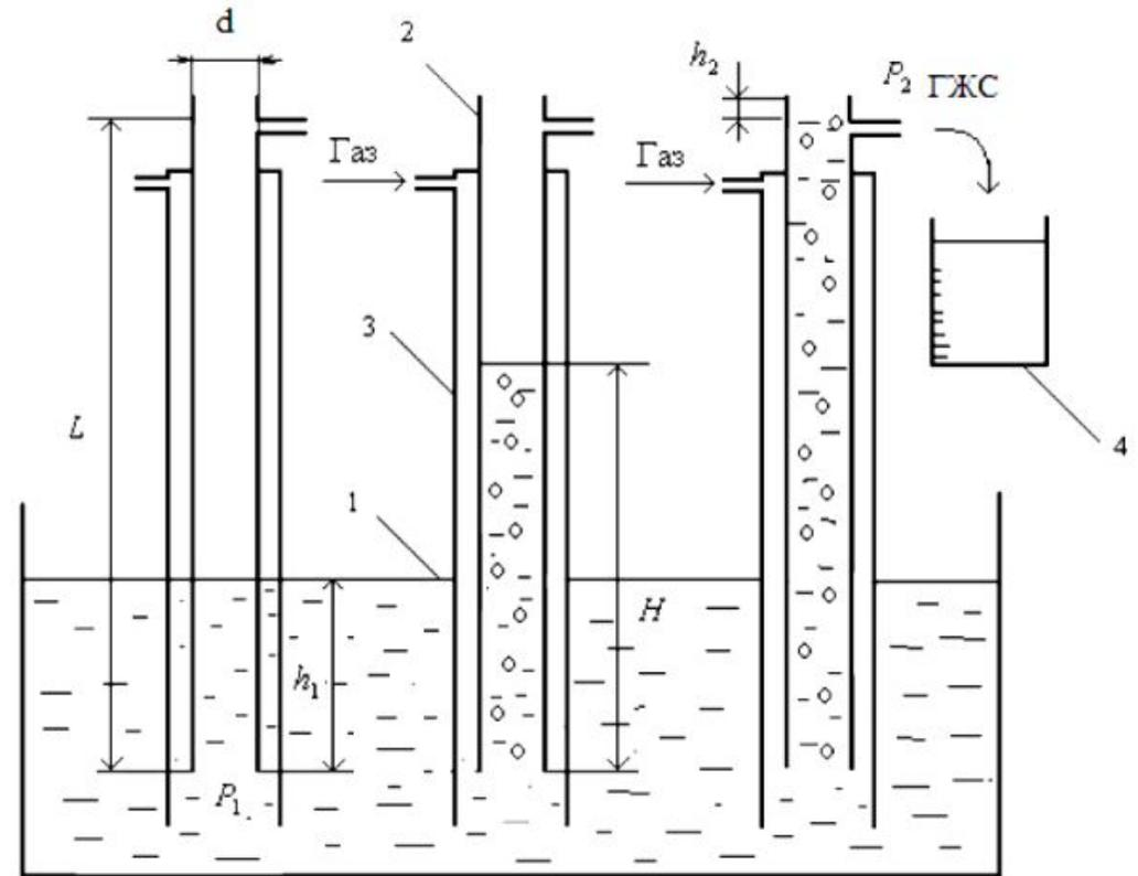
Рис. 1.3 Принципиальная схема газожидкостного подъемника
