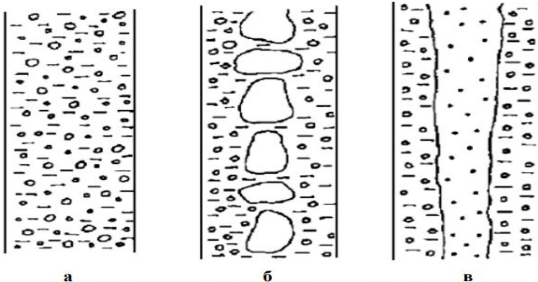
**Рис. 1.4 Схематическое изображение основных структур восходящего газожидкостного потока:**
