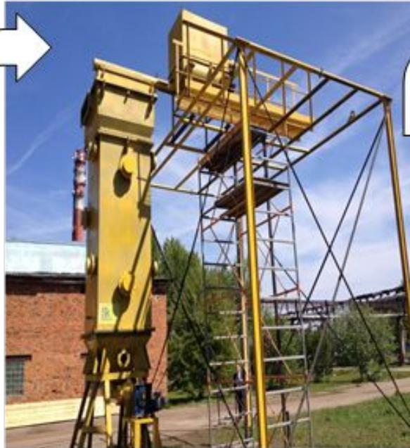
Блок очистки и разделения парогазов
