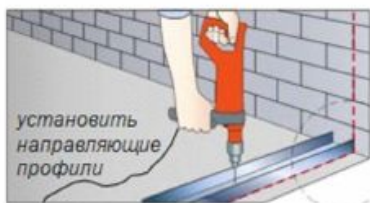
Рис. 3 - Установка направляющего профиля по выполненной разметке
