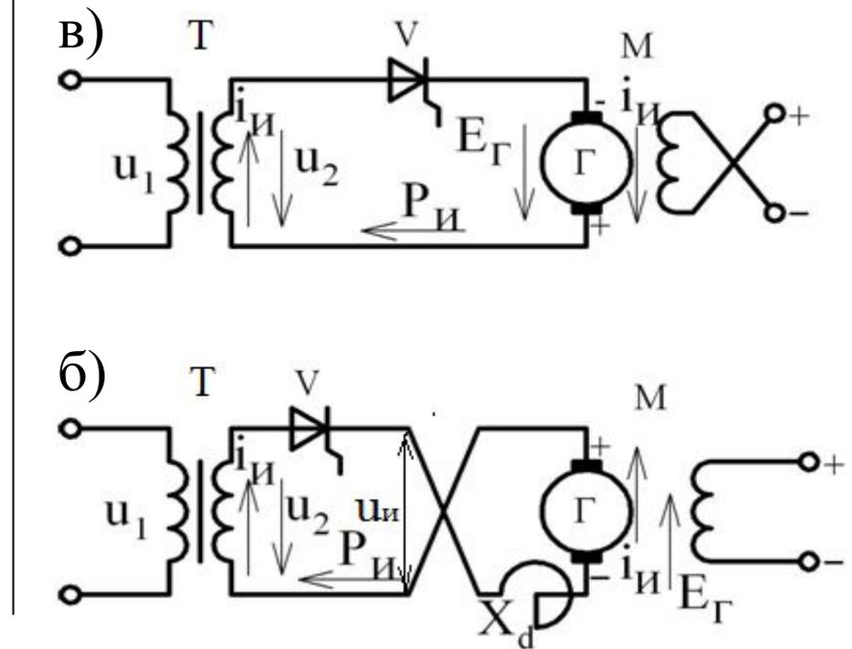
Рисунок 7.1.1 – Принципиальные схемы работы системы преобразователь-электровоз в выпрямительном(а) и инверторном(б) режимах
