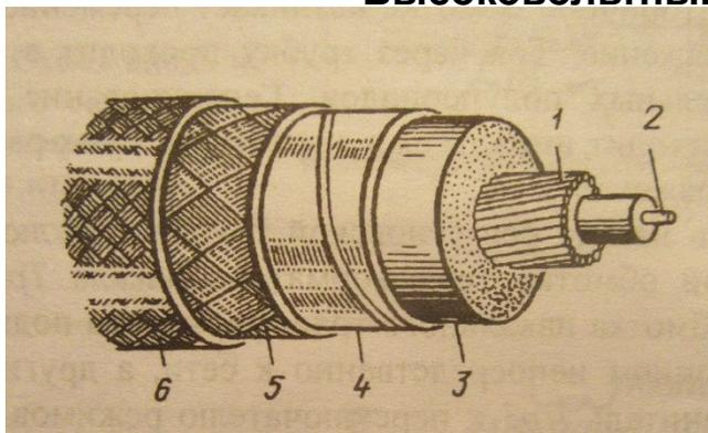
**1, 2 – токопроводящие жилы; 3 – резиновая изоляция; 4 – противокоронный слой; 5 – металлическая защитная оболочка; 6 – внешняя оболочка**
